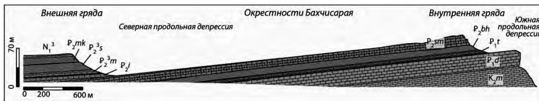
Рис. 1. Геолого-геоморфологический профиль Предгорного Крыма в районе Бахчисарая. Условные обозначения: K_2m – мергеля маастрихта, сверху песчанистые; P_1d – известняки датского яруса; P_1t – мергели танетского яруса; P_2bh – глины известковистые бахчисарайского яруса с прослоями глинистых известняков и мергелей; P_2sm – нуммулитовые известняки симферопольского яруса; P_2i – мелоподобные известняки низов верхнего эоцена; P_2^3m – верхнеэоценовые глинистые мергели и глины; P_2^3s – верхнеэоценовые зеленоватые глины; P_2mk – олигоценовые глины и пески; N_1^3 – известняки сармата.
