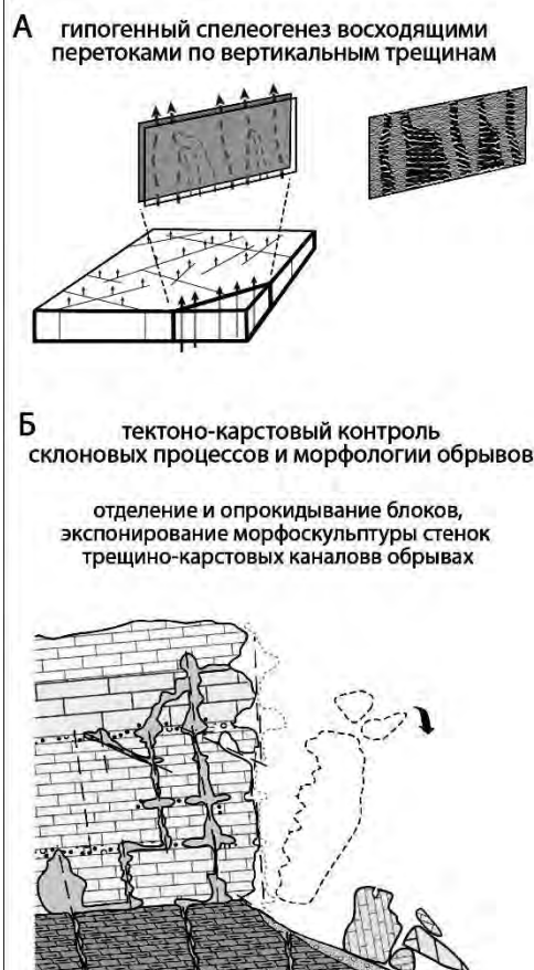
Рис.2. Концептуальная модель «поперечного» гипогенного спелеогенеза в пластовой структуре (А) и обобщенная схема строения гипогенной карстовой системы Внутренней гряды (Б). Схема Б также иллюстрирует тектоно-карстовый контроль склоновых процессов и морфологии обрывов.
