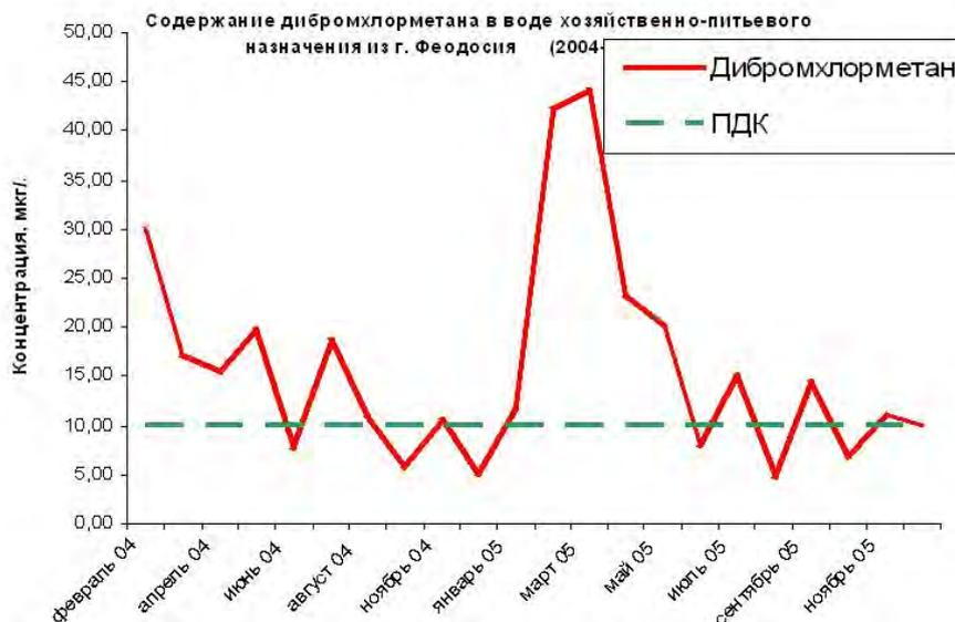
Рис. 1. Содержание дибромхлорметана в воде питьевого назначения в г. Феодосии в 2004 – 2005 г.г.
