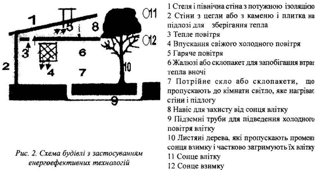
Рис. 2. Схема будівлі з застосуванням енергоефективних технологій
