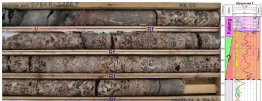
Рис. 5. Фотография керна (граница отложений вендской и рифейской систем, интервал 2764,6–2776,7 м) (Масленников М. А., 2015 с дополнениями) и каротажные диаграммы скважины Шушукская 1
