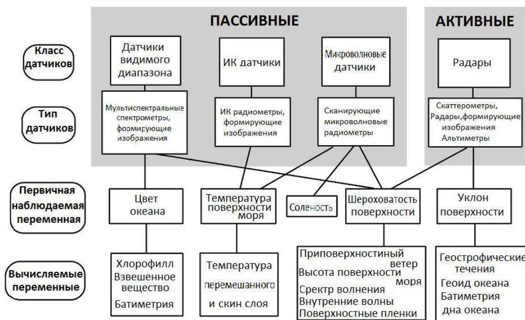
Рис. 3. Схема, иллюстрирующая различные методы измерений и типы датчиков, используемых в дистанционном зондировании, а также их применение. [Робинсон, 2010]
