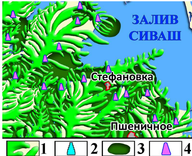
Рис. 7. Пример расположения скважин перехвата вод естественной разгрузки. М 1:100 000.
