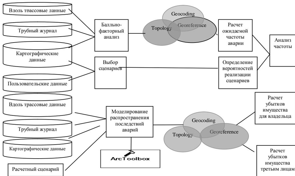
Рис. 2. Блок схема «Технологическая схема Анализа частоты».
