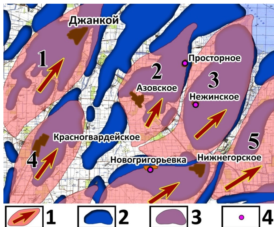
Рис. 4. Совмещение дельтообразных структур с впадинами в пределах Просторненского, Нежинского и Новогригорьевского водозаборов. М 1:100 000. Условные обозначения: 1 — дельтообразные структуры и их направленность; 2 — локальные впадины; 3 — зоны совмещения дельтообразных структур с впадинами; 4 — местоположение водозаборов.
