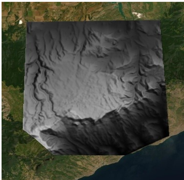
Рис. 5. Теневой рельеф карстового массива Караби, полученный в результате преобразования сглаженного растрового слоя SRTM.
