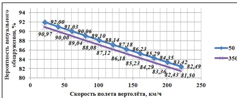
Рис. 8. Вероятность визуального обнаружения МО в зависимости от скорости и высоты полёта вертолёта (50м, 350м) при угле  $\alpha = 90^\circ$  в ПМУ.
