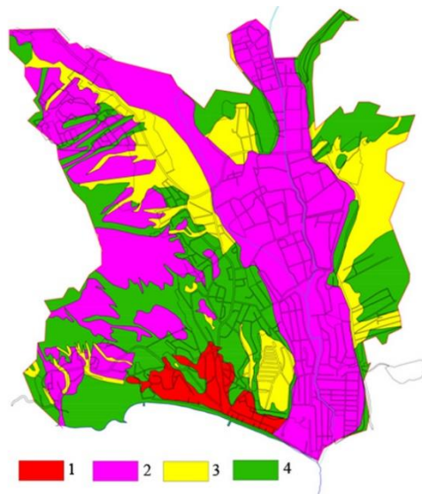
Рис. 5. Просадочные свойства четвертичных отложений города Судака 1 — сильнопросадочные грунты; 2 — среднепросадочные; 3 — слабопросадочные; 4 — непросадочные.
