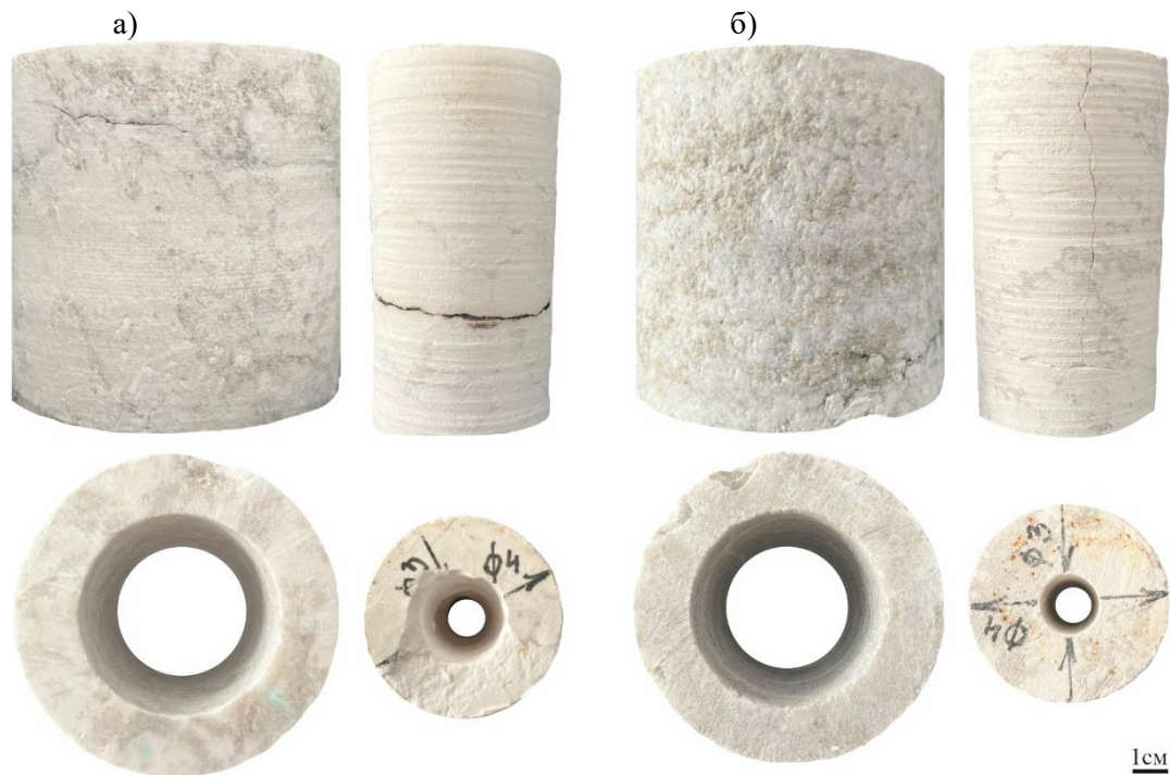
Рис. 2. Общий вид образцов ненарушенной структуры (слева) и испытанных образцов (справа): гипс в зоне крупной карстовой полости (а) и за ее пределами (б)
