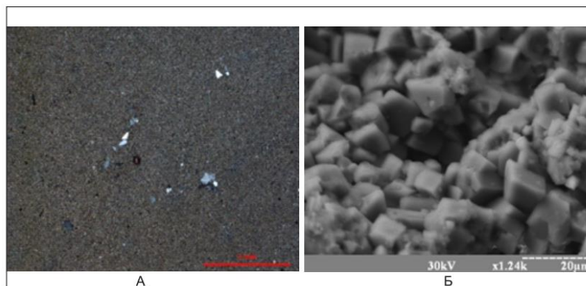
Рис. 4. Фото шлифа породы (А) и поверхность скола доломита (Б)
