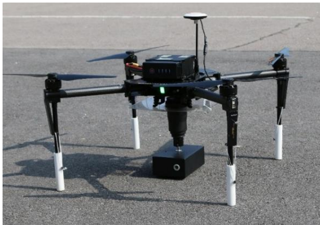
Рис. 1. Опытный образец используемого в работе беспилотного комплекса химической разведки грунта
